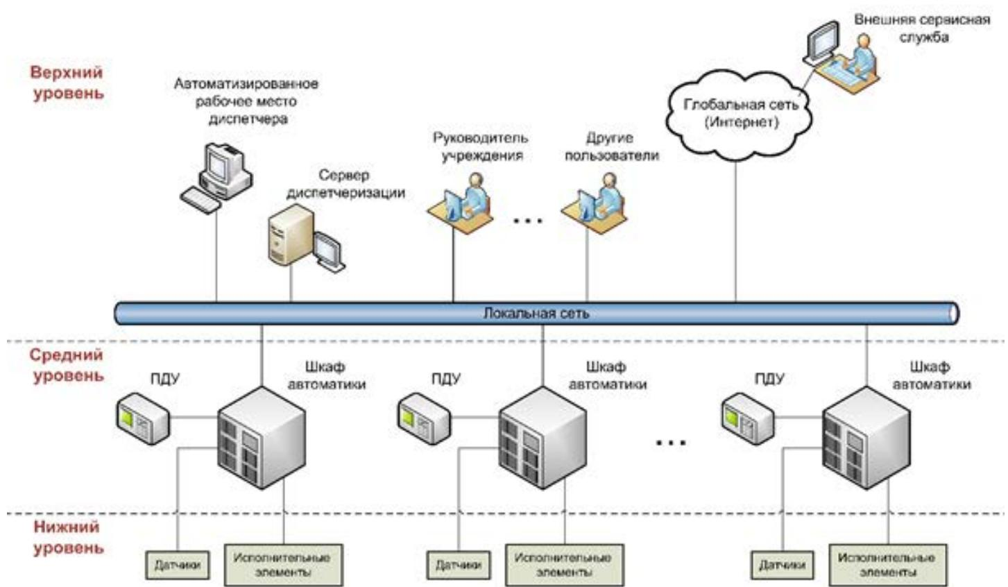
Нижний уровень системы состоит из исполнительных устройств (двигателей, насосов, клапанов и т.п.) и датчиков контроля параметров функционирования оборудования.
