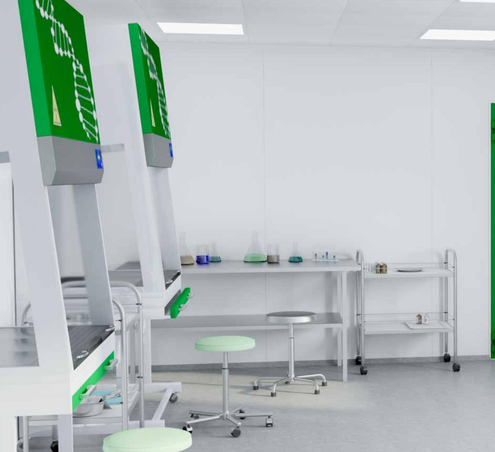
Чистое помещение – помещение, в котором контролируется счетная концентрация аэрозольных частиц (в т.ч. и патогенов), и которое построено и используется так, чтобы свести к минимуму поступление, генерацию и накопление частиц внутри помещения, и в котором, при необходимости, контролируются другие параметры, например, температура, влажность и давление.
